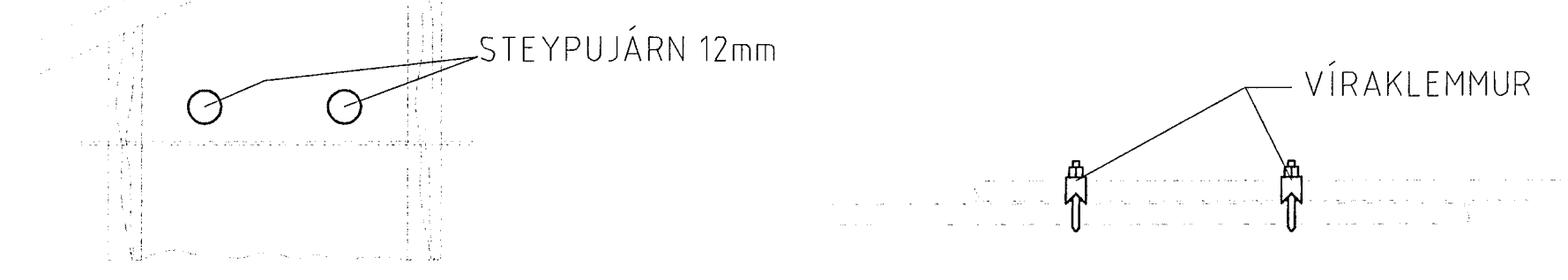
SAMTENGING STEYPUSTEINA SETJA SKAL TVÖ VÍRLÁSA Á HVER SAMSEYTI
