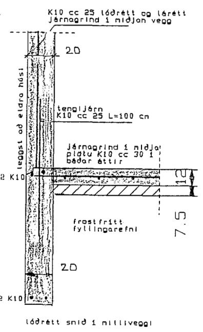
allt lífrænt efni skal fjarlægð og grafið niður á fastan botn, fyllingarefni innan í og umhverfis sakkla skal vera frostfritt efni og þjappað í mest-30 cm lagum og hleytt dýpt sakkla á fyllingu má vera 60-120 cm. Þar sem sakkla standa á klapp er lágmarksdýpt sakkla 30 cm og skal tekið tillit til frárennslis og regnvatnslagna.
