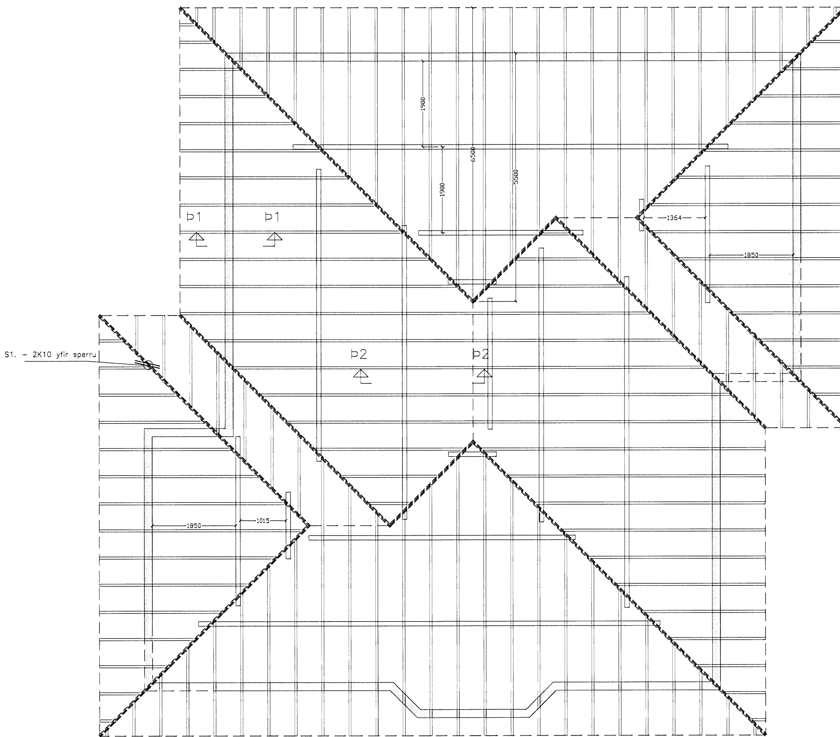
Sperrur 50 x 100mm c/c 600mm en kverksperrur 50 x 125mm
