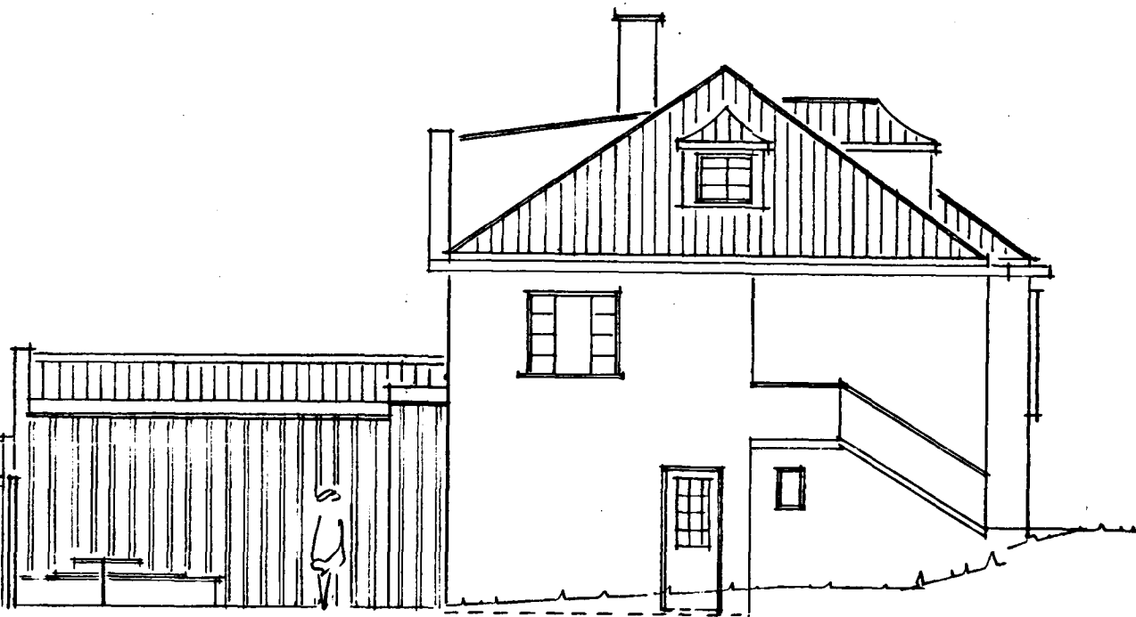
N-V eftir breytingu hlið bílskúrs einangruð og klædd með standandi timburklæðningu.
