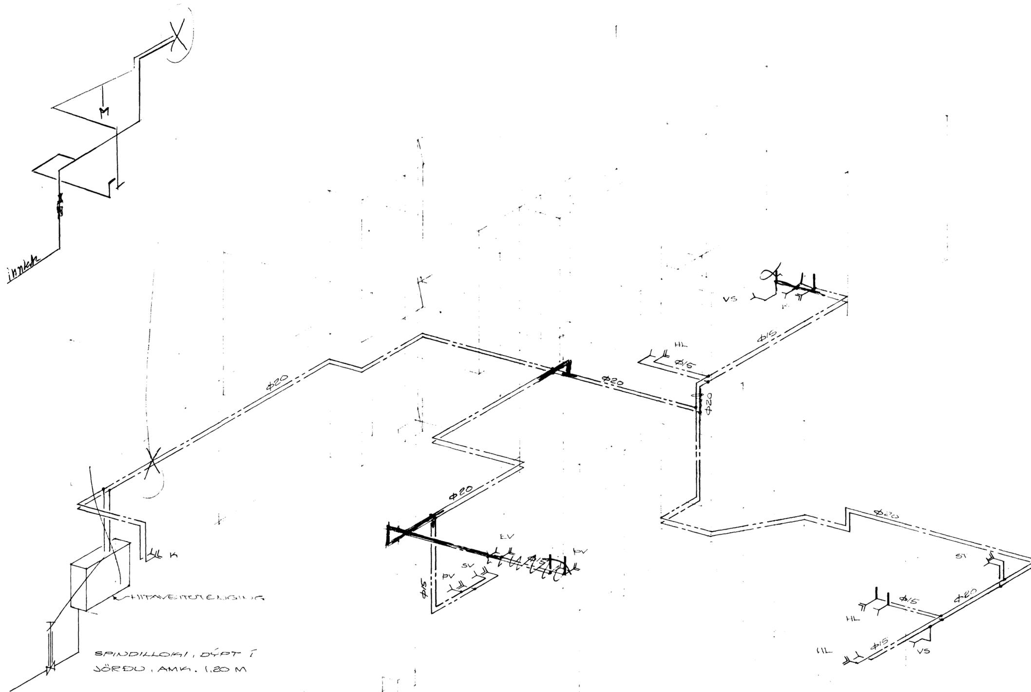
HÍÐUR SÉU GALVANISERADAR OG EILYNGRADAR
