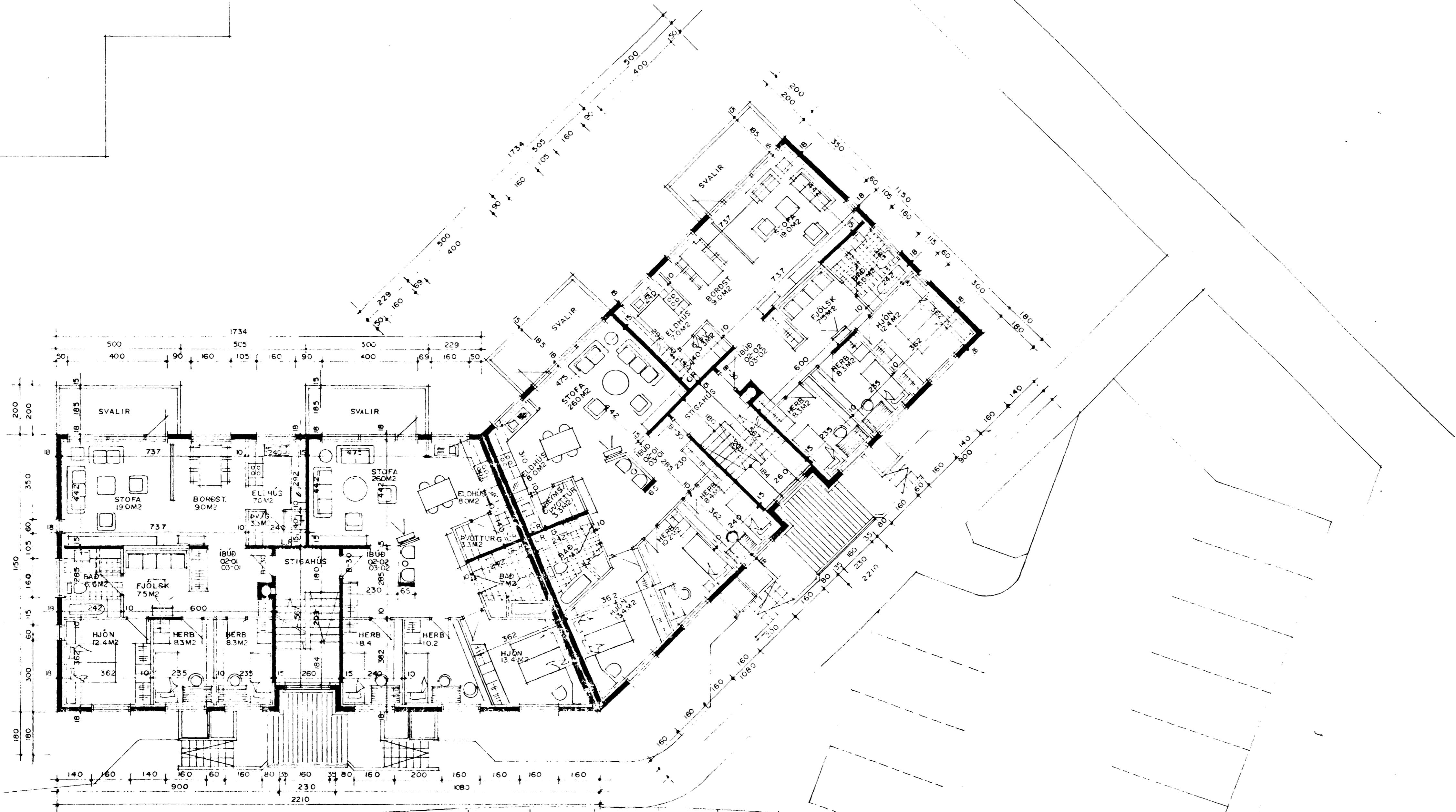
GRUNNMYND 2. OG 3. HÆÐAR MKV. 1:100
