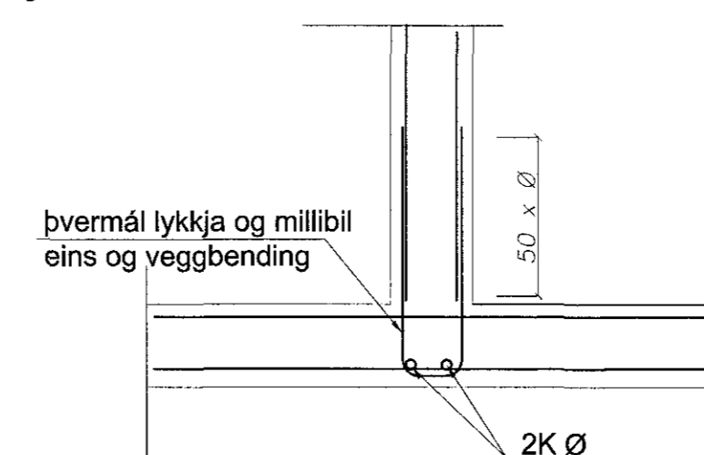
Snið 4: Tenging veggja tvöföld grind.
