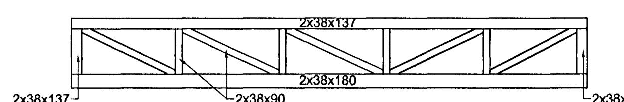
**BITI B1:** Biti er tvöfaldur og er hvor hluti settur saman með sama hætti og kraftsperrur. Bitahlutar eru neglir saman og virka sem einn biti. Biti festist niður á vegggrind með 2xBMF þakásankerí grunnform 370, negling 2x8 stk 40/40 kambsaumur í hvort ankeri.
