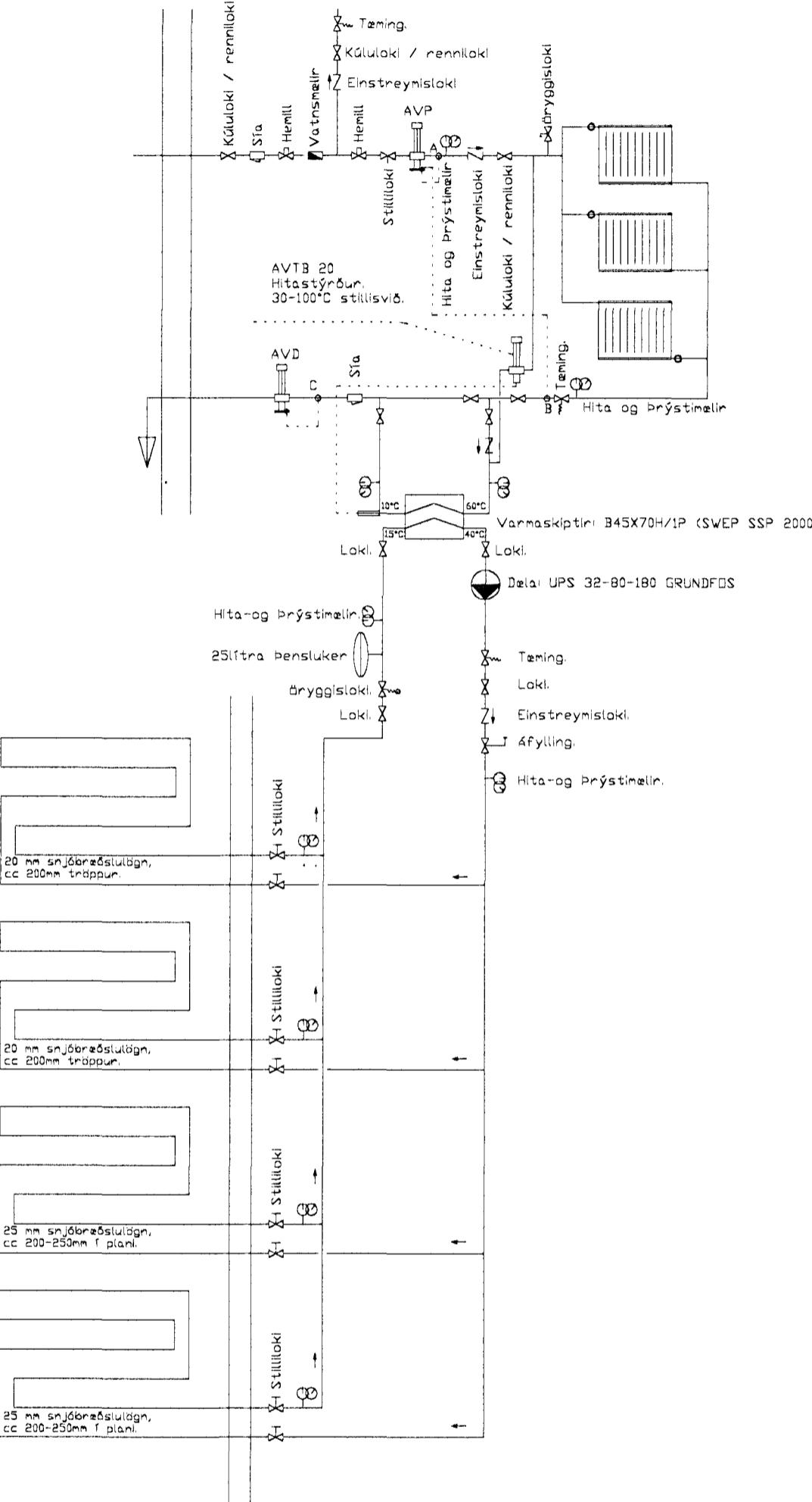
Húsatenging einnfalt kerfi með varmaskiptir fyrir snjóbraðslu.
