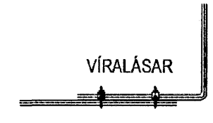
SAMSETNING STEYPUSTYRKARJÁRNS: EKKI SKAL NOTA FÆRRI EN TVO VÍRALÁSA Á SAMSEYTI. FJARLÆGD MILLI VÍRALÁSA U.P.B. 200 mm
