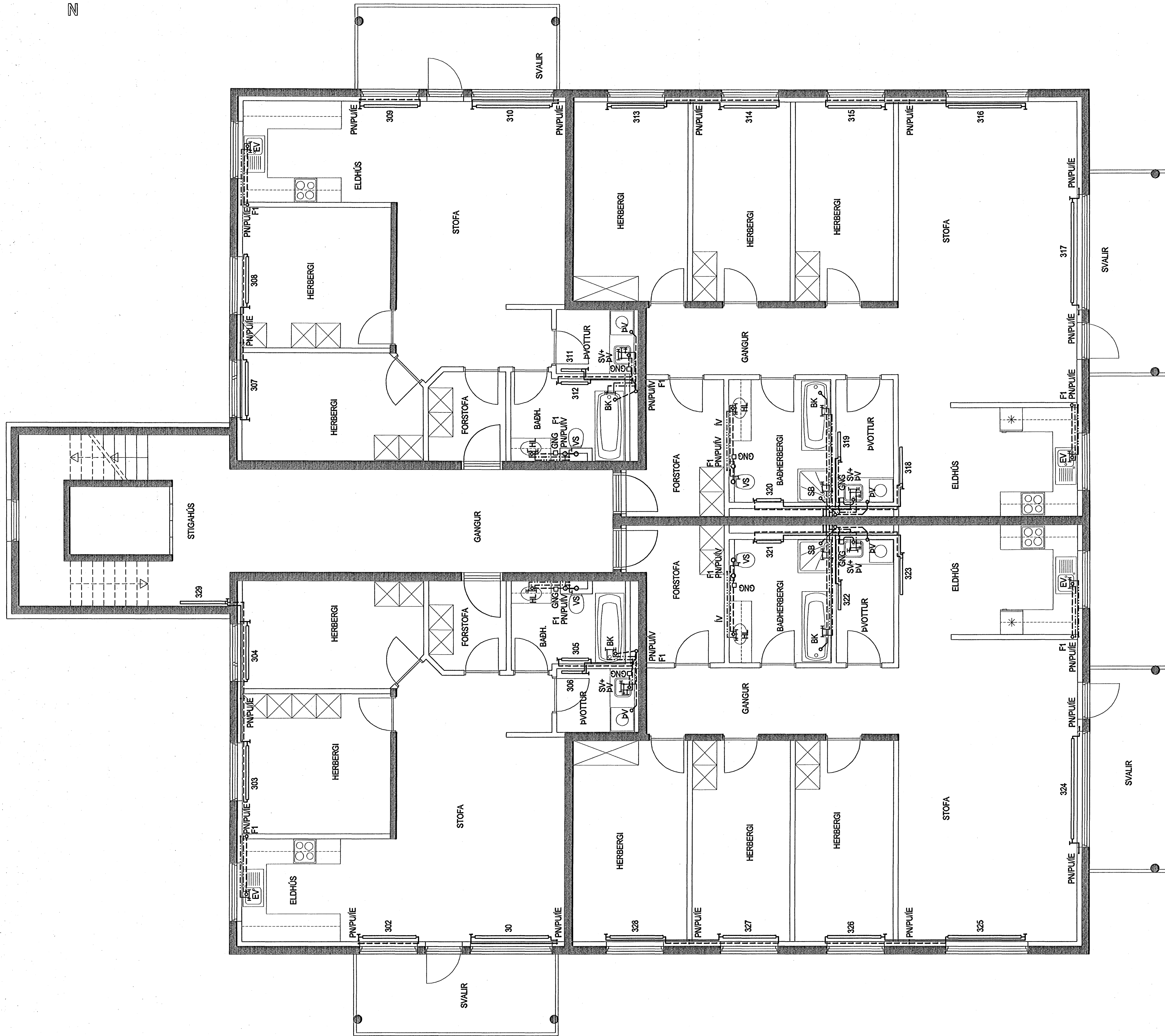
NEYSLUVATNS-, HIT- OG FRÁRENNISLAGNIR GRUNNMYND 3. HÆÐAR MKV. 1:50
