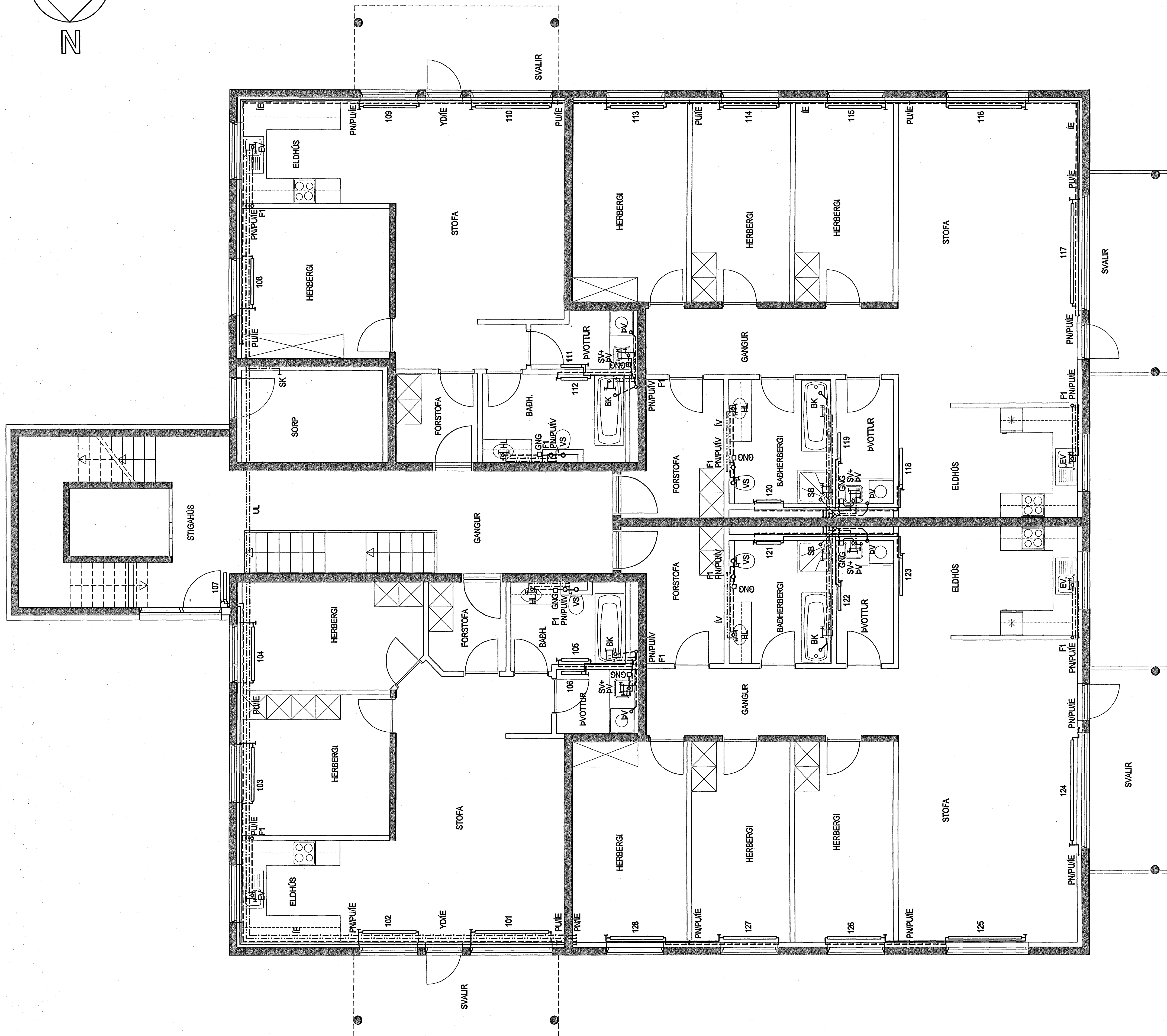
NEYSLUVATNS- HITA- OG FRÆRENNISLAGNIR GRUNNMYND 1. HÆÐAR MKV. 1:50
